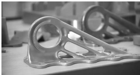
Рис.1. 3Д-печатная металлическая деталь компании Airbus
