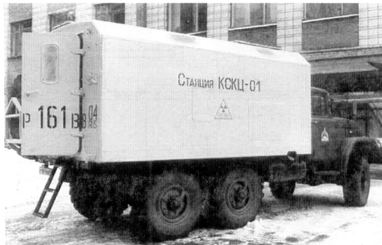
Рис. 5. Автомобиль ЗИЛ-131 с КУНГом, в котором размещены пультовая и технологический отсек для установки оборудования станции КСКЦ-01
