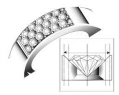
Рис. 3. Схема закрепки мелких драгоценных камней «паве»[5]
