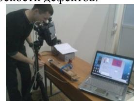
Рисунок 3. Проведение индукционной инфракрасной термографии.
