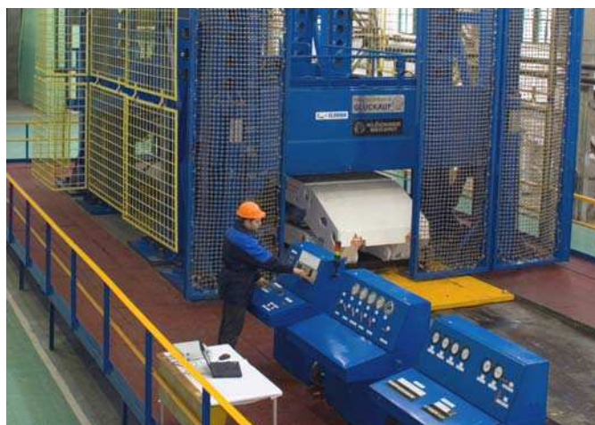
Рис. 2. Испытательный стенд «Gluckauf» с секцией крепи МКЮ.2Ш-26/53
