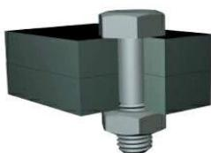
Рис.1.Пример разъемного соединения (Болтовое)
