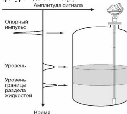
**Рис.3** Технология рефлектометрии с временным разрешением
