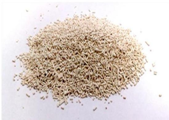
**Рис. 1. Внешний вид сорбционного материала КФГМ-7**
