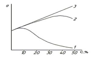
Рис. 1. Принципиальная зависимость прочности (σ) полимерного материала от содержания (С,%) наполнителя:1-дисперсного; 2- волокнистого рубленого; 3-армирующего (непрерывное волокно, тканый наполнитель)
