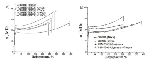
Рис.4. Зависимости напряжения разрушения от деформации для образцов с различными: А) процентным содержания меди, Б) видом наполнителя
