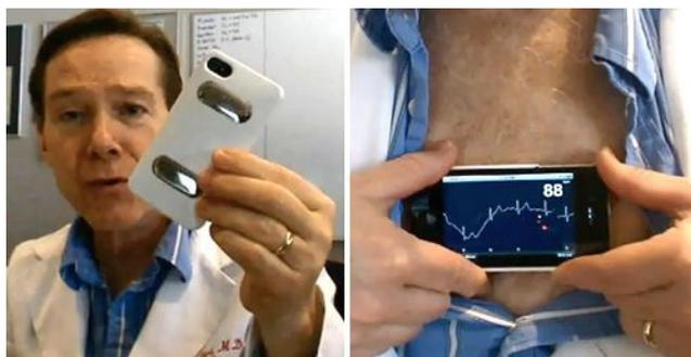
Рис. 1. Чехол для регистрации ЭКГ для мобильного телефона компании AliveCor
