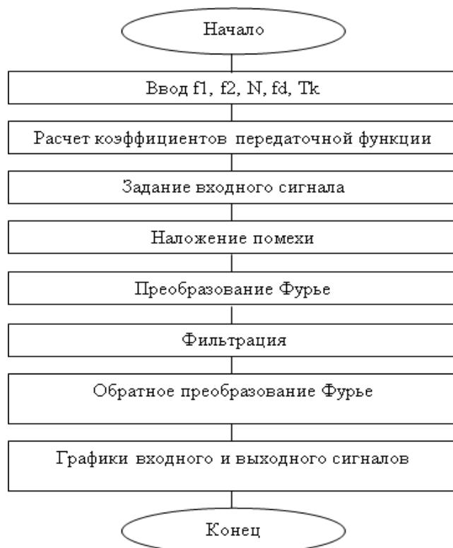
Рис. 1. Алгоритм реакции цифрового фильтра на входной сигнал методом частотной выборки
