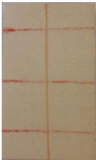
Рис. 1. Тест-панель №1, обработанная дефектоскопическими материалами: А– Vycotest; В– Sherwin
