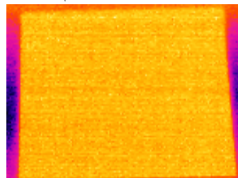
в) нагрев полосовым резистивным нагревателем мощностью 2 кВт, вручную перемещаемым вдоль поверхности объекта контроля
