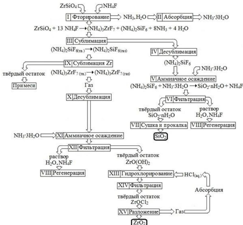
Рис. 1. Схема переработки цирконового концентрата
