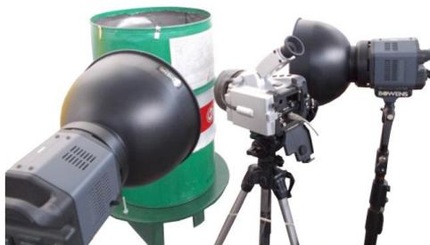
Рисунок 3 – ИК термографическая система для контроля коррозии в цилиндрических изделиях
