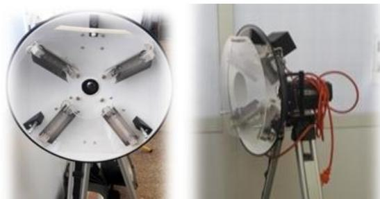
Рисунок 9 – Прототип теплового дефектоскопа с галогеновым источником нагрева
