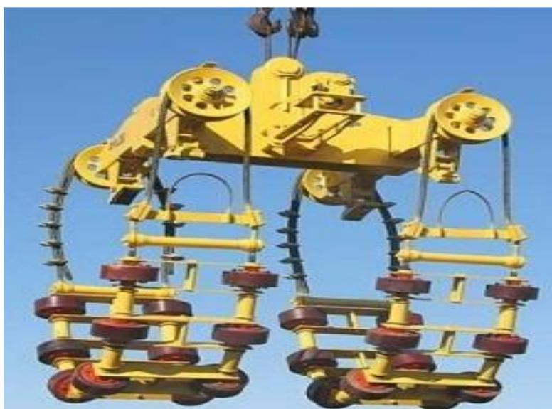
Рисунок 10 – Подвеска троллейная роликотканатная РТП-1020 РС
