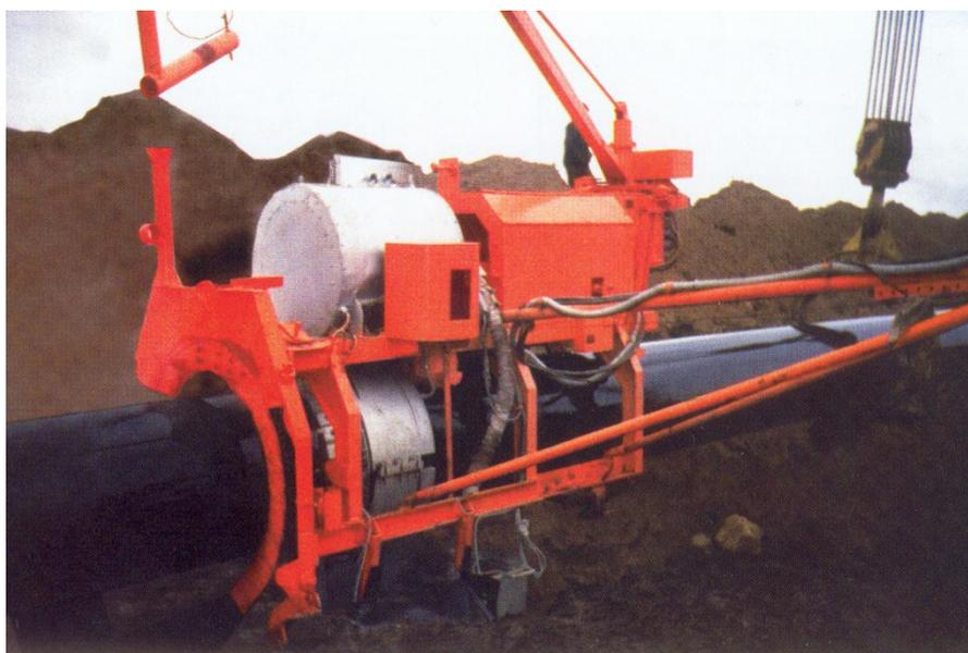
Рисунок 2 – Изоляционная машина типа МИАБ
