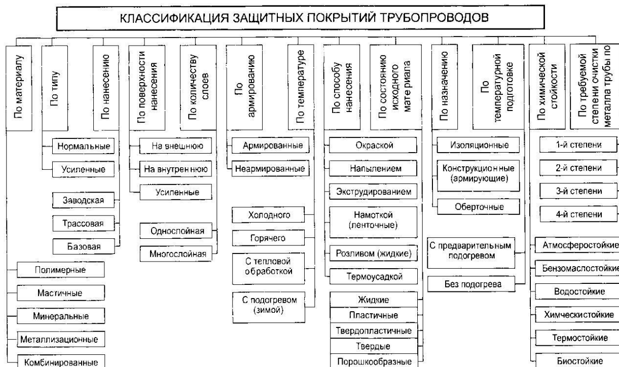
Рис. 2.1 Классификация защитных покрытий трубопровода
