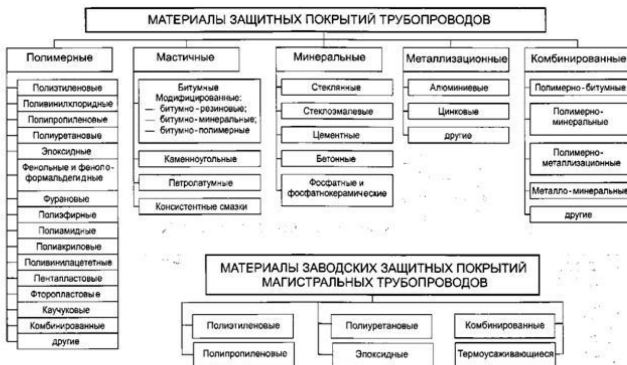
Рис. 2.2 Классификация материалов защитных покрытий трубопроводов
