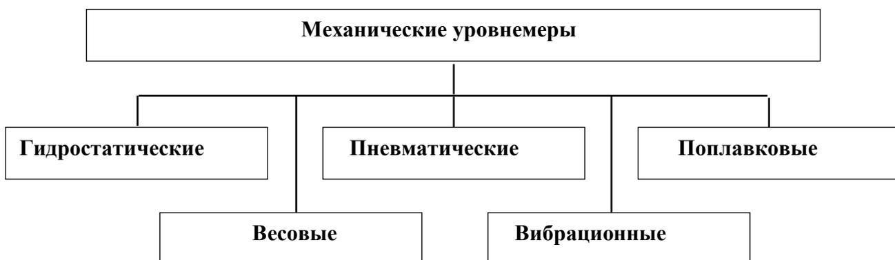
Рисунок 2 – Классификация механических устройств измерения и контроля уровня жидкостей
