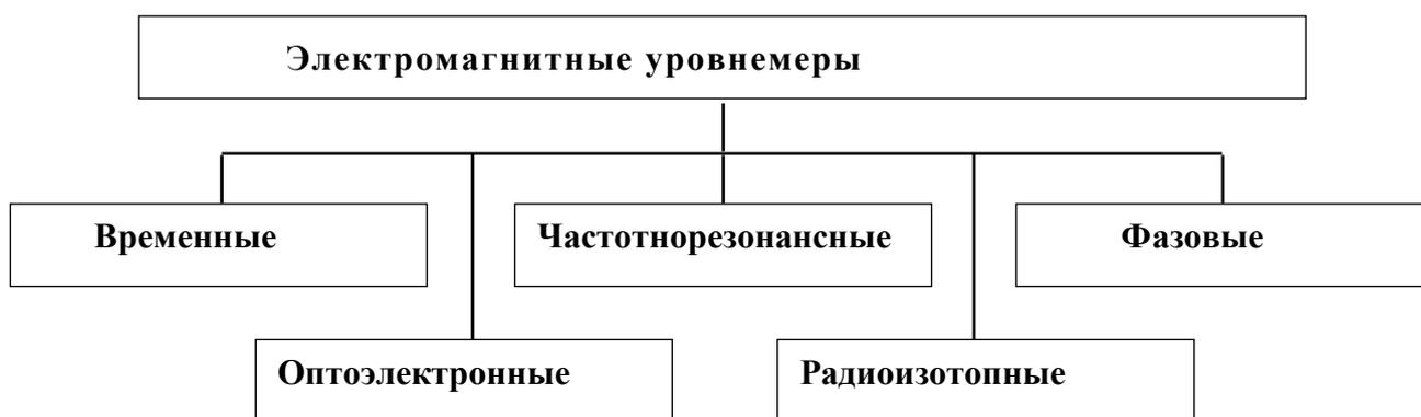
Рисунок 5 – Классификация электромагнитных устройств измерения и контроля уровня жидкостей
