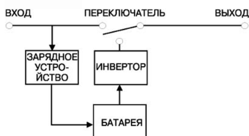
Рисунок 2.1 – схема ИБП off – line типа.
