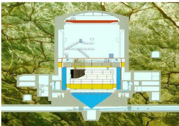
Рисунок 1 – Расположение промышленного реактора в горном массиве.
