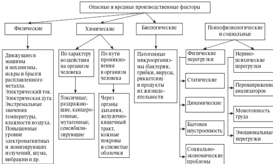
Рис.1 Классификация опасных и вредных производственных факторов
