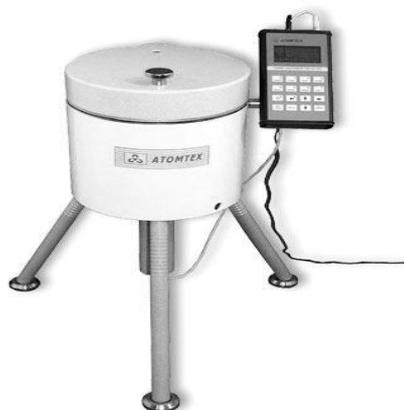
Рис. 2 Гамма-радиометр
