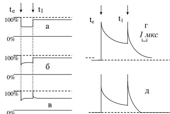
**Рис. 2.** Осциллограммы изменения поглощения (а, б, в) и люминесценции (г, д) в максимумах полос при последовательном воздействии на кристалл  $KCl$ :  $I$  импульсов электронного и лазерного возбуждения: полос поглощения локализованных примесью экситонов – а (1,65 эВ), б (3,7 эВ), в –  $F$ -полосы (2,3 эВ), г – гетероядерных экситонов (2,65 эВ), д – полосы на 3, 4 эВ. Стрелками вверху показана моменты воздействия импульсов электронного  $t_e$  и лазерного пучков  $t_l$
