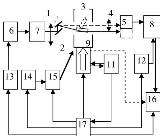
**Рис. 1.** Блок-схема импульсного оптического спектрометра. 1, 4) линзы; 2) зеркала; 3) исследуемый образец; 5, 7) монохроматоры; 6 – импульсная лампа; 8) фотоэлектронный умножитель; 9) криостат; 10) импульсный наносекундный высокопоточный ускоритель электронов, 11) пульт управления; 12) блок питания фотоэлектронного умножителя; 13) блок питания импульсной лампы; 14) блок накачки лазера; 15) импульсный лазер; 16) осциллограф; 17) генератор импульсов ГИ-1
