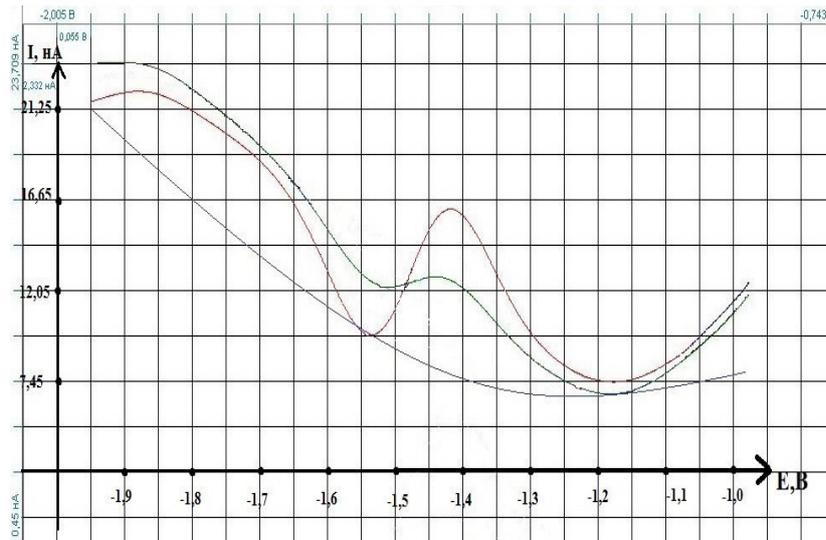
Рис.1. Вольтамперограмма о-фторбензонала на фоне 0,1 М  $\text{NaH}_2\text{PO}_4$
