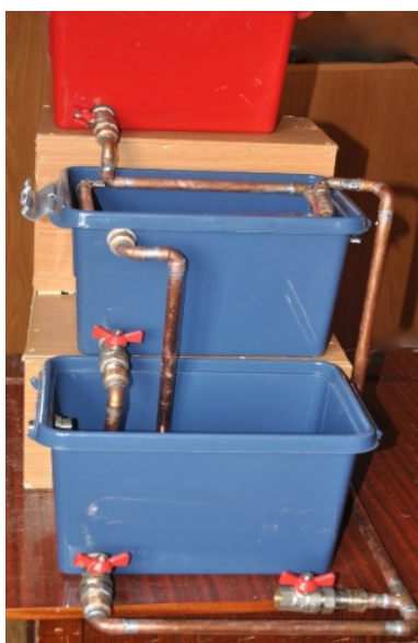
Рис. 1. Лабораторная установка биологической очистки
