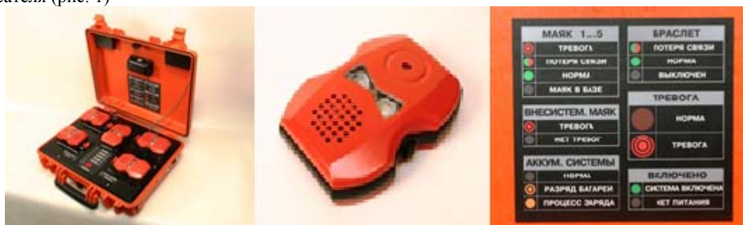
Рис.1. Комплекс аппаратуры для обнаружения места нахождения спасателя (пожарного), попавшего в критическую ситуацию при ликвидации чрезвычайной ситуации (пожара)
