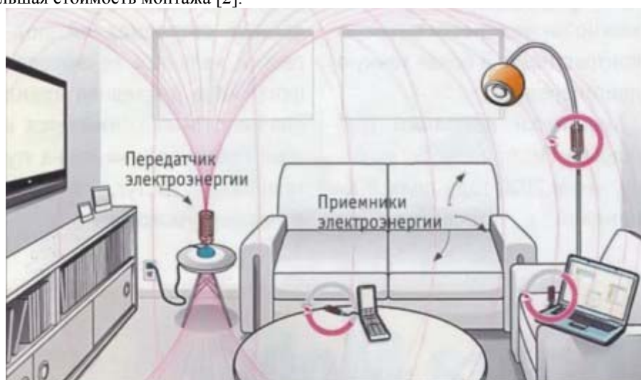
Рис. 2. Схема работы беспроводных технологий в квартире
