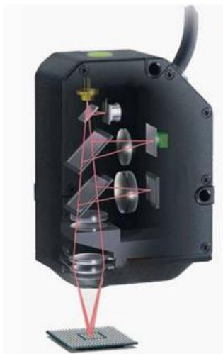
Рисунок 1.7 – общий вид внутренней компоновки конфокального датчика [14]
