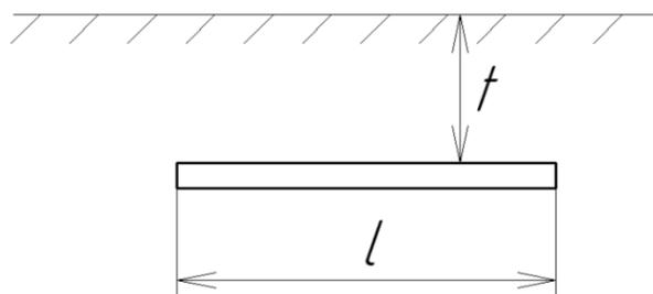
Рисунок 15. - Горизонтальный заземлитель
