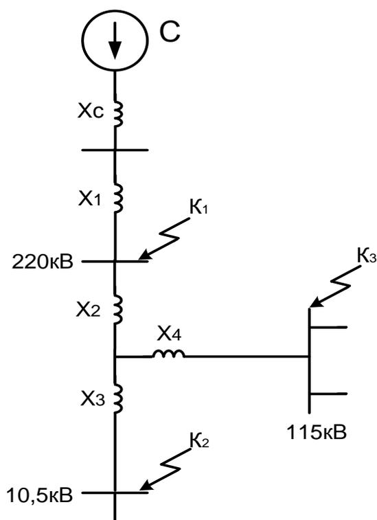
Рисунок 2.2 – Схема замещения
