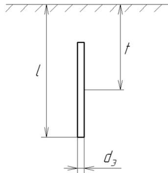
Рисунок 14. - Вертикальный заземлитель
