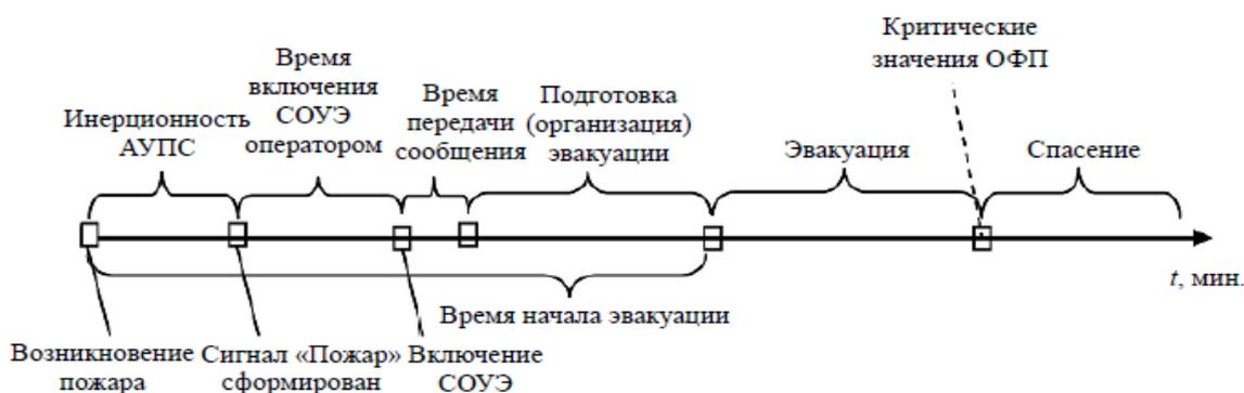
Рисунок 2.5 - Интервалы затрат времени при возникновении пожара
