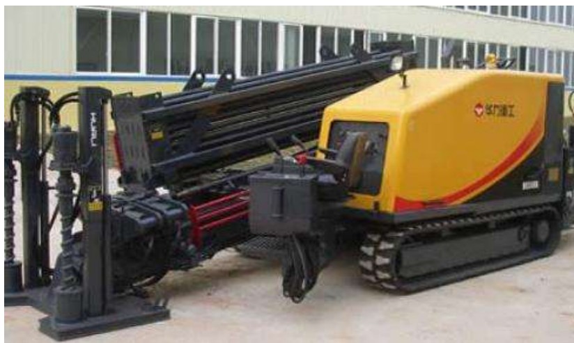
Рисунок 3 – Буровая установка, используемая при ННБ
