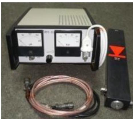
Рисунок 1.1 – Внешний вид высоковольтного аппарата для испытания изоляции ИМ-60
