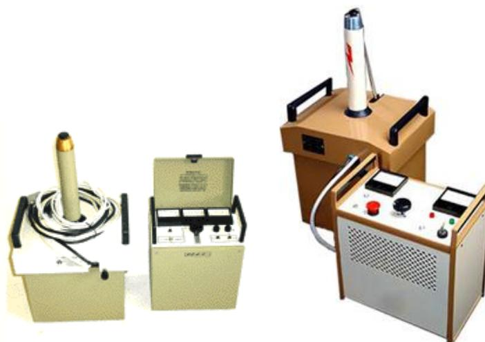
Рисунок 1.2 – Внешний вид установки для испытания силовых кабелей АИД-70/50
