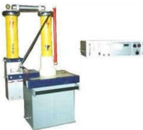
Рисунок 1.3 – Внешний вид аппаратов высоковольтных АВ-70-2 и АВ-70-0,5
