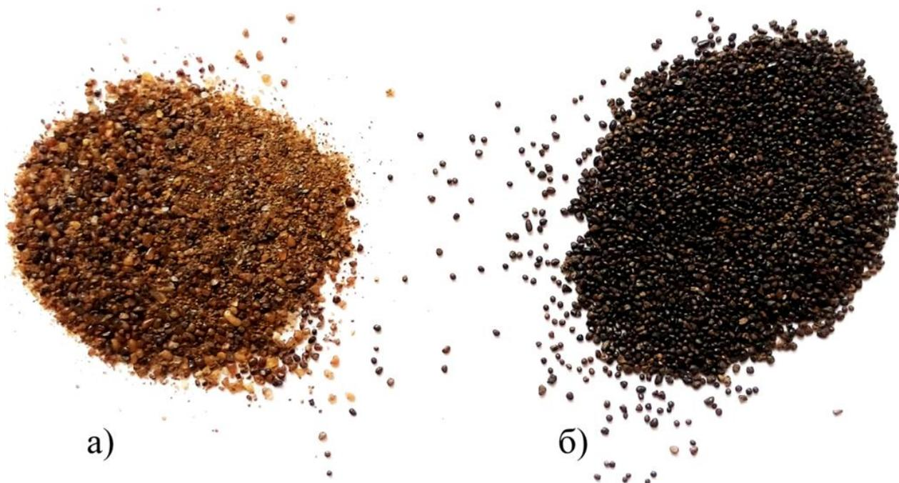
Рисунок 22 – Железная руда после магнитной сепарации:
