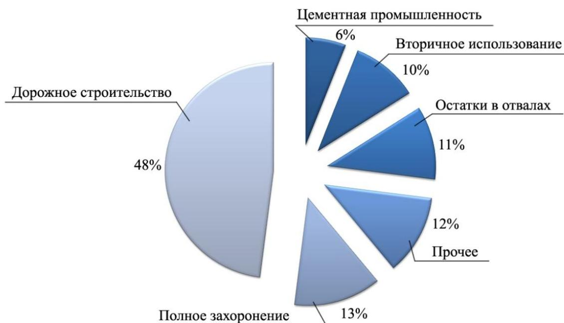
Рисунок 1 – Использование сталеплавильных шлаков в странах ЕС в 2010 г [10]
