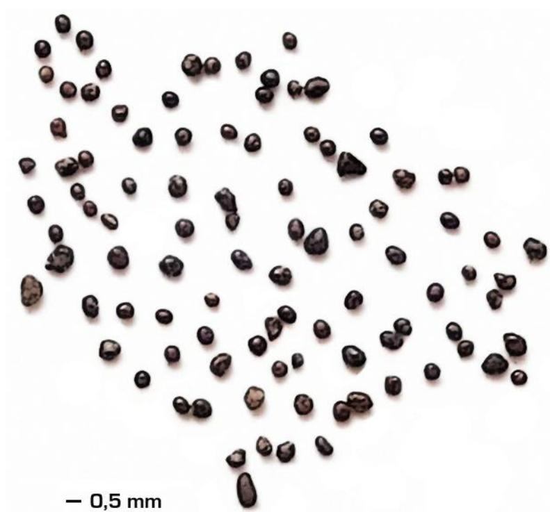
Рисунок 19 – Фотография частиц железного концентрата
