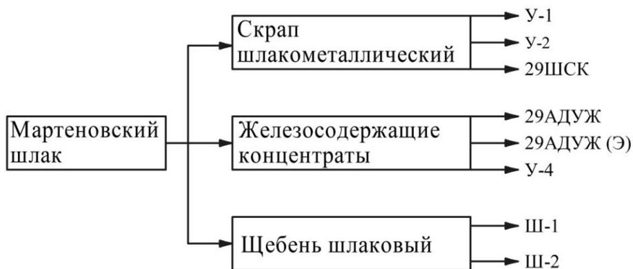
Рисунок 16 – Продукция, получаемая при переработке мартеновских шлаков
