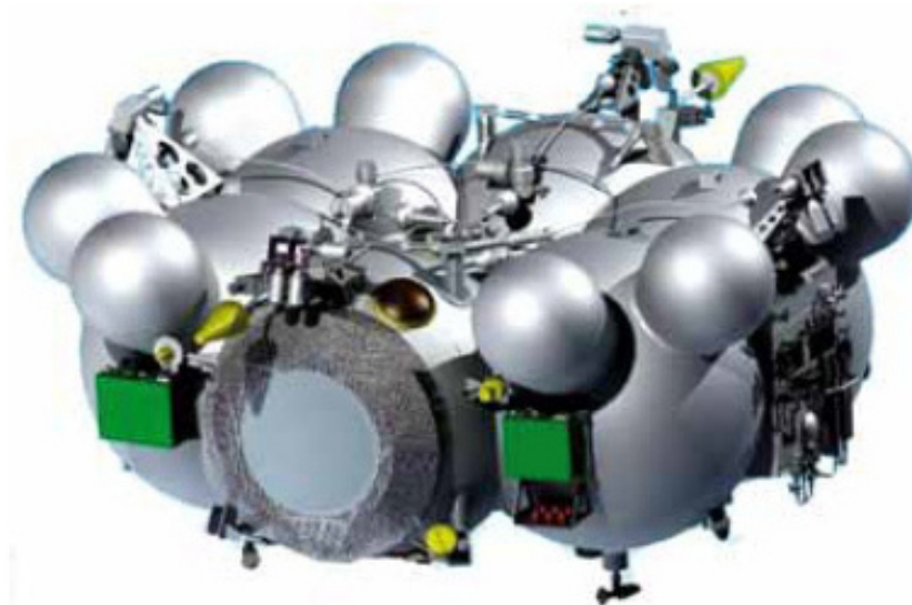
Рисунок 6.3 – РБ «Фрегат» с большими дополнительными емкостями, запас топлива = 7150 кг
