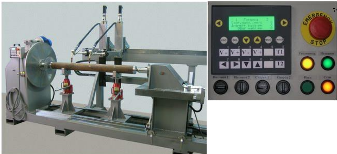
Рисунок 8 – Универсальная установка АС354-2 для наплавки цилиндрических и конических поверхностей и пуль управления
