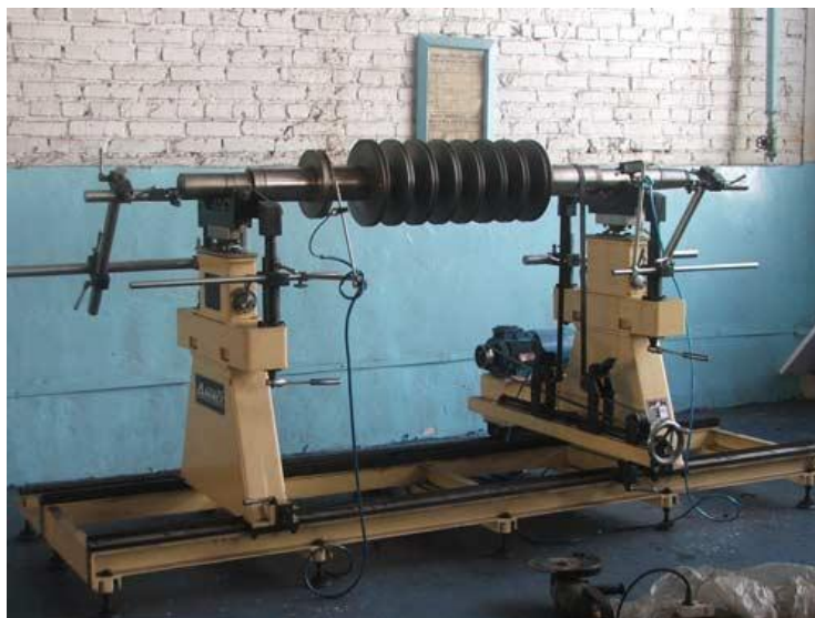
Рисунок 11 – Балансировочный станок зарезонансного типа серии ВМ–1000
