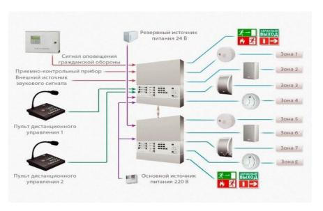
Рисунок 6 – Составные элементы системы оповещения о возгорании
