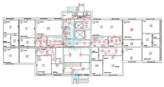
Рисунок 10.Пример размещение оборудования для одного подъезда дама На приборе C2000M размещены различные виды контактов для выдачи тревожных сигналов и сигналов управления.
