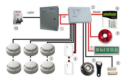
Рисунок 8 – Комплектация адресной пожарной сигнализации.
