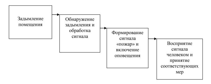
Рисунок 10 – Блок-схема работы ИП 212-50М
