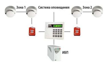
Рисунок 7 – Строение пороговой пожарной сигнализации.
