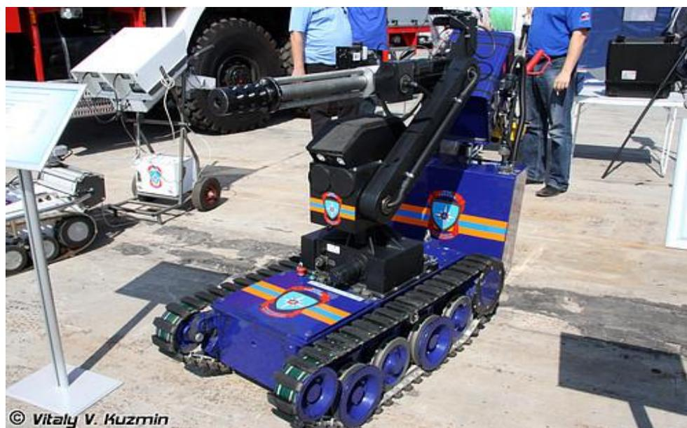
Рисунок 12 – Робототехнический комплекс MF-4
