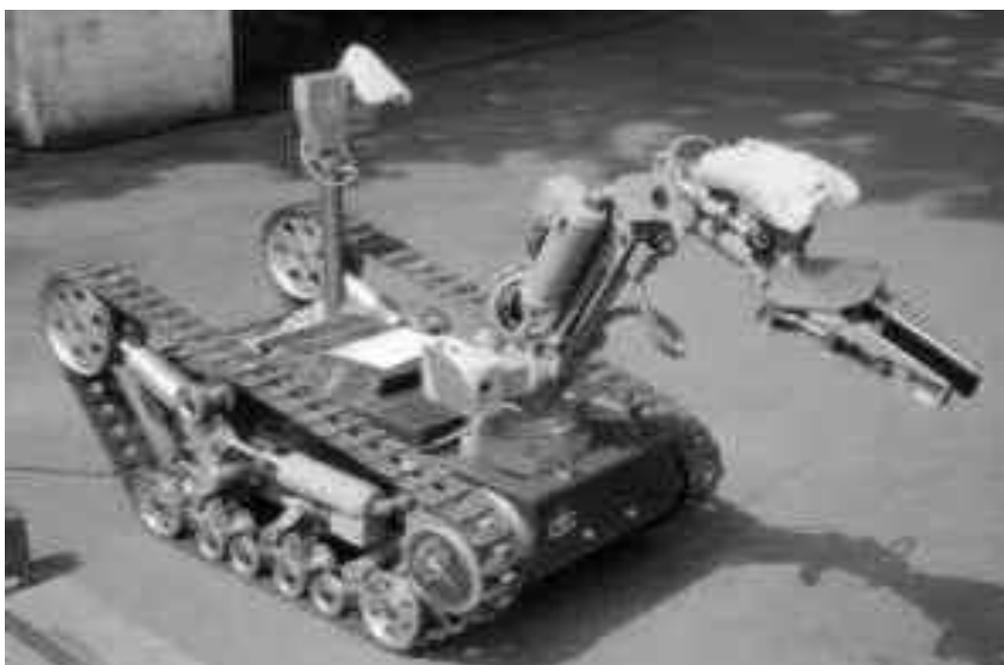
Рисунок 1 – МРК-25 Россия, предназначен для проведения взрывотехнических работ в составе соответствующих подразделений ФСБ и МЧС РФ. В 1997 г. МРК-25 являлся экспериментальным комплексом и не проходил полномасштабных испытаний.
