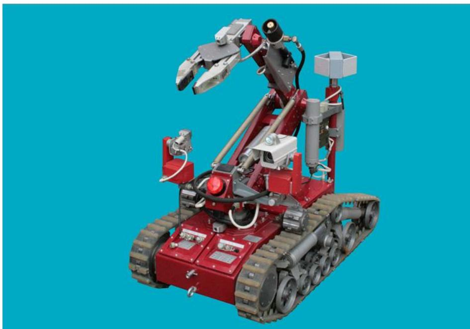
Рисунок 20 – Мобильный робототехнический комплекс разведки и пожаротушения
