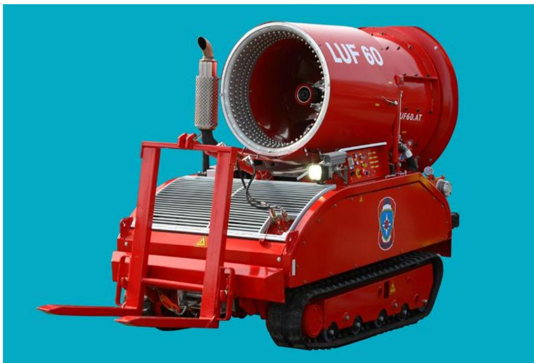
Рисунок 21 – Мобильная установка пожаротушения «LUF-60»
