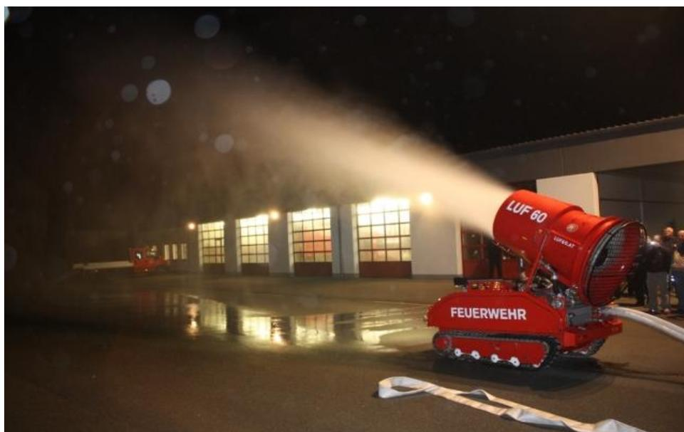
Рисунок 8 – Дистанционно-управляемая мобильная установка пожаротушения LUF-60
