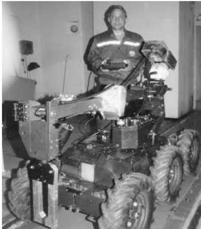
Рисунок 2 – Мобильный робот “НОВО” фирмы Kentree (Ирландия) из состава криминалистической взрывотехнической лаборатории ФСБ России. Предназначен, в первую очередь, для применения в составе подразделений силовых структур при выполнении взрывотехнических работ и проведении антитеррористических операций. Возможно использование робота при борьбе с огнем, а также на предприятиях атомной энергетики и химической промышленности для работ с радиоактивными и ядовитыми веществами и отходами производства.
