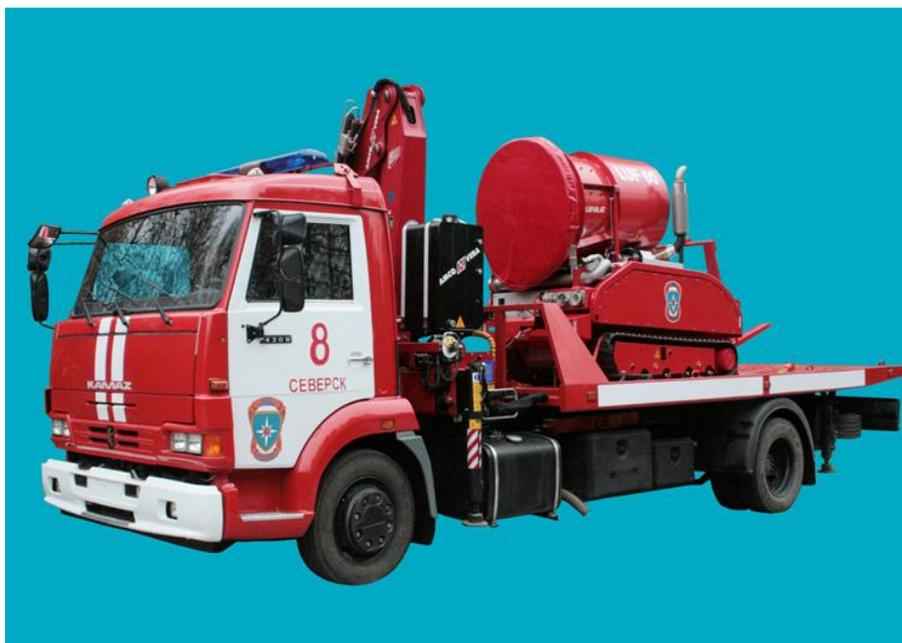
Рисунок 19 – Эвакуатор со сдвижной платформой и крано-манипуляторной установкой
