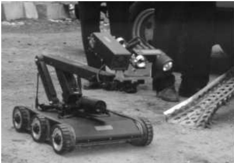
Рисунок.3 – Мобильный робот “RASCAL” фирмы Kentree (Ирландия) из состава криминалистической взрывотехнической лаборатории ФСБ России. Используется совместно с более тяжелыми машинами в составе взрывотехнических подразделений.
