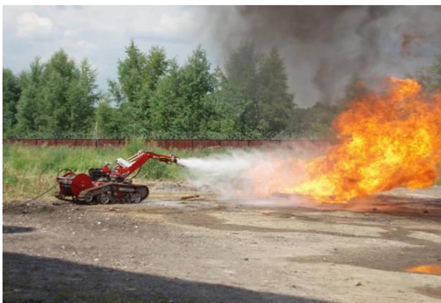
Рисунок 7 – Противопожарный робототехнический комплекс легкого класса для работы в условиях высокого уровня теплового воздействия и радиации МРК-РП
