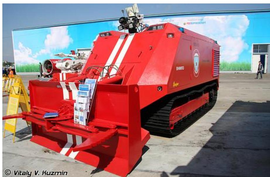
Рисунок 10 – Мобильный роботизированный комплекс тяжелого класса ЕЛЬ-10
