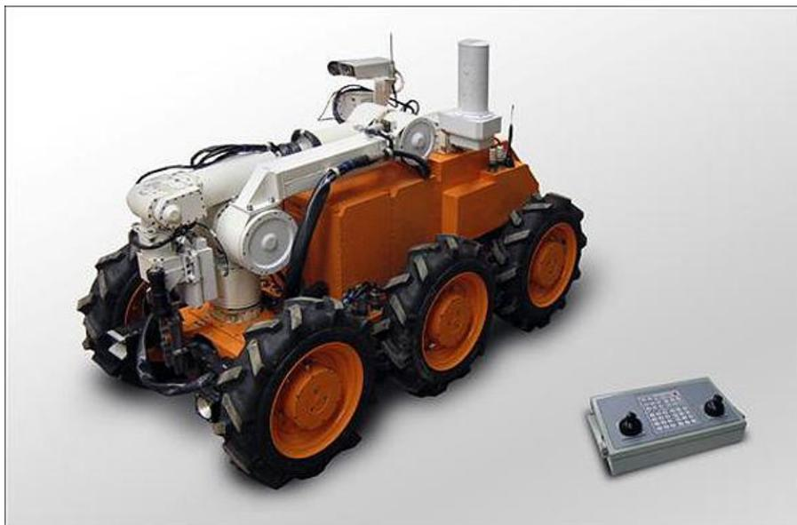
Рисунок 6 – Робот радиационной разведки РТК-05 – единственное устройство, которое принято на вооружение войск радиационной, химической и биологической разведки российской армии.
