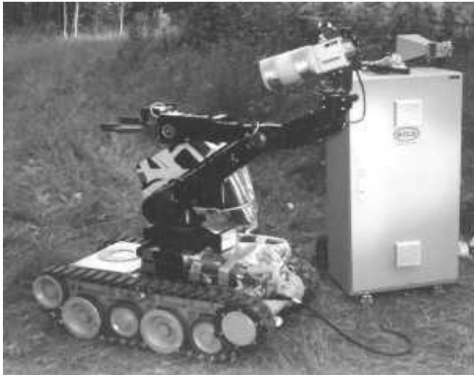
Рисунок 4 – МРК MV-4, фирма Telerob (ФРГ) принадлежащий аварийно-техническому центру ВНИИЭФ, предназначен главным образом для работы с опасными объектами на предприятиях атомной энергетики и химической промышленности.
