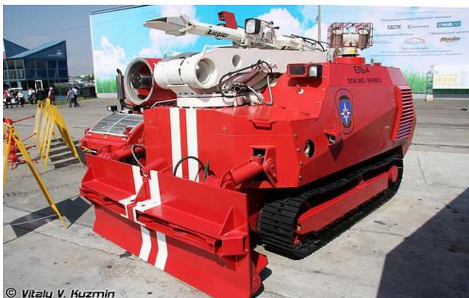
Рисунок 9 – Мобильный роботизированный комплекс среднего класса «ЕЛЬ-4»
