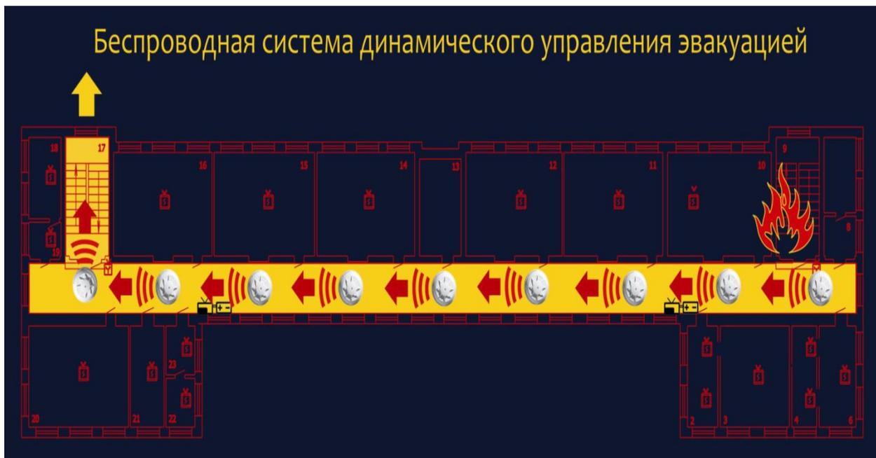
Рисунок 11- Принцип работы система динамического управления эвакуации.
