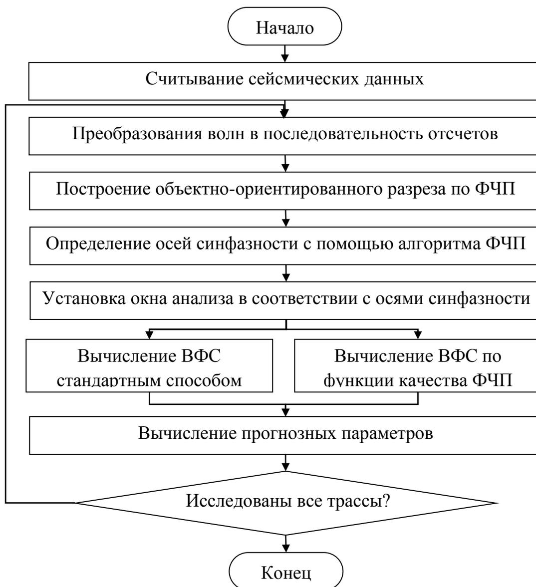
Рисунок 2.5 – Структурная схема алгоритма прогноза свойств геологического разреза
