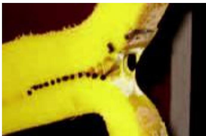
Рисунок 30 – Испытание на разрыв образца из сварного соединения
