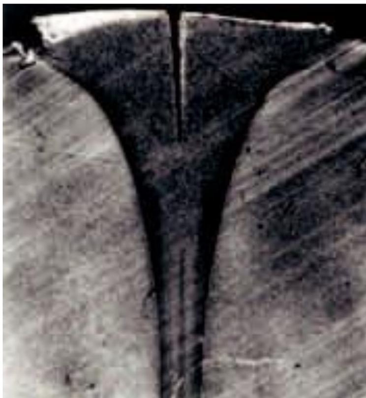
Рисунок 25 – Образование дефекта в сварном соединении при попадании частиц пыли
