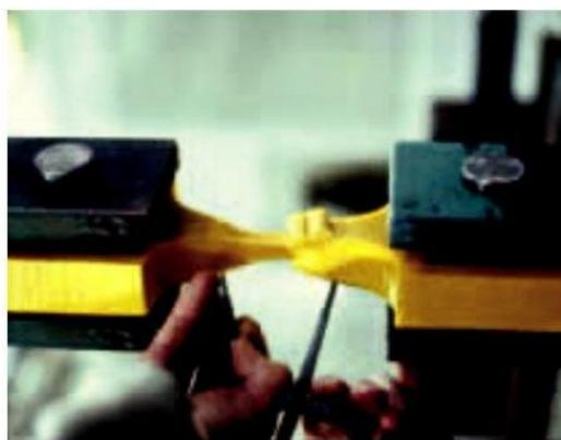
Рисунок 27 – Испытание на растяжение образца сварного шва
