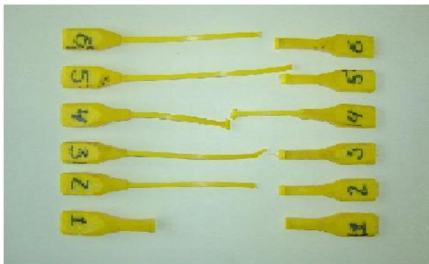
Рисунок 34 – Разрушенные образцы-лопатки со сварным швом.
