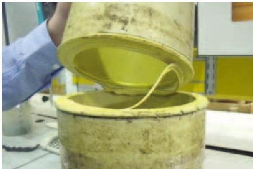
Рисунок 21 – Разрушение шва при смещении кромок
