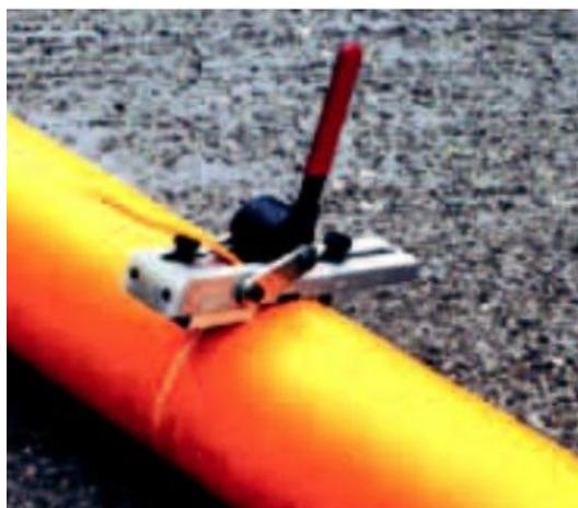
Рисунок 26 - Процесс удаления грата при помощи специального инструмента
