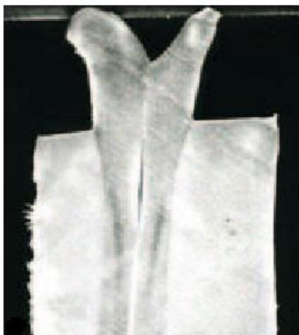
Рисунок 23 – Брак сварного соединения при недостаточном времени плавлении кромок
