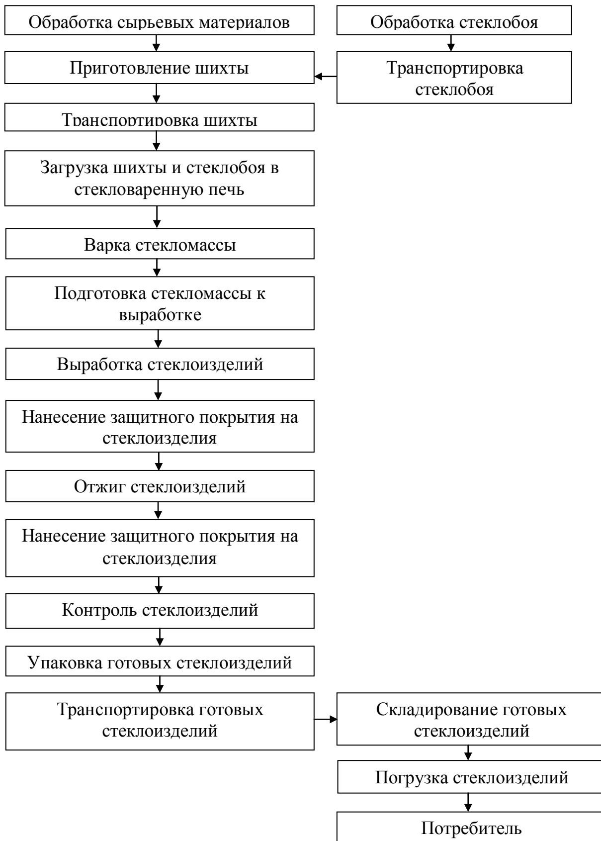
Рисунок. 1. – Технологическая схема производства стеклотары
