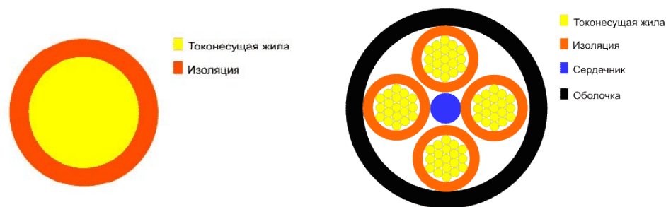
Рисунок 4 - Конструкция одножильного и многожильного кабелей
