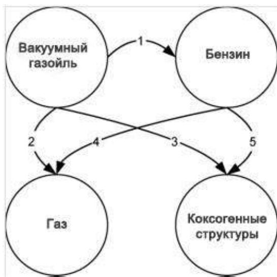
Рисунок 1.2 – Схематическое представление четырехкомпонентной модели КК Питаулта и соавт.(1995)
