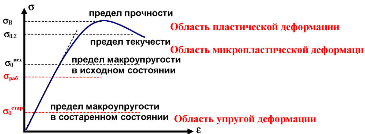
Рисунок 1.6 – Влияние старения на прочностные свойства стали.
