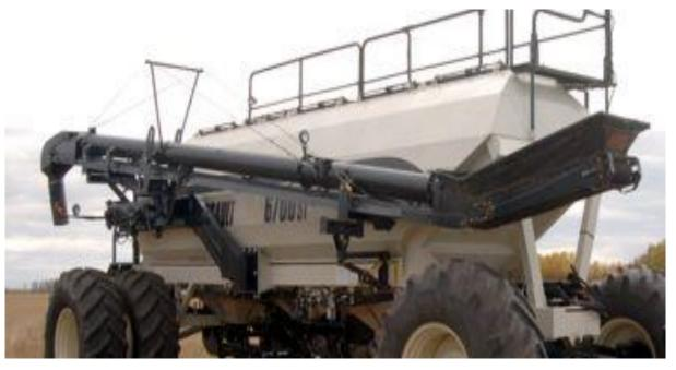
Рисунок 3.2 - бункер BOURGAULT Модель 6700ST
