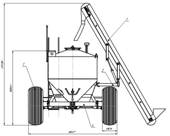
Рисунок 3.5 – Проектируемый загрузчик семян посевного комплекса ПК-8,5
