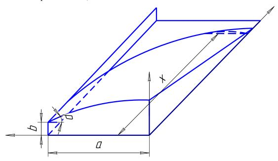
Рисунок 3.6 - Схема к расчету параметров загрузочного устройства
