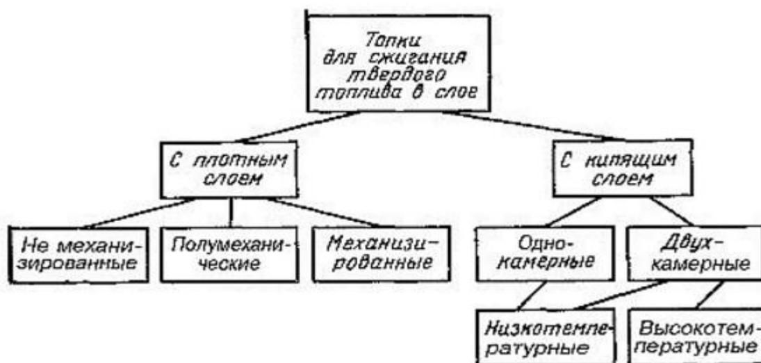
Рисунок 4 – Классификация слоевых топок
