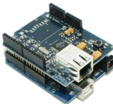
Рисунок 3.11 – Установленный модуль Ethernet Shield
