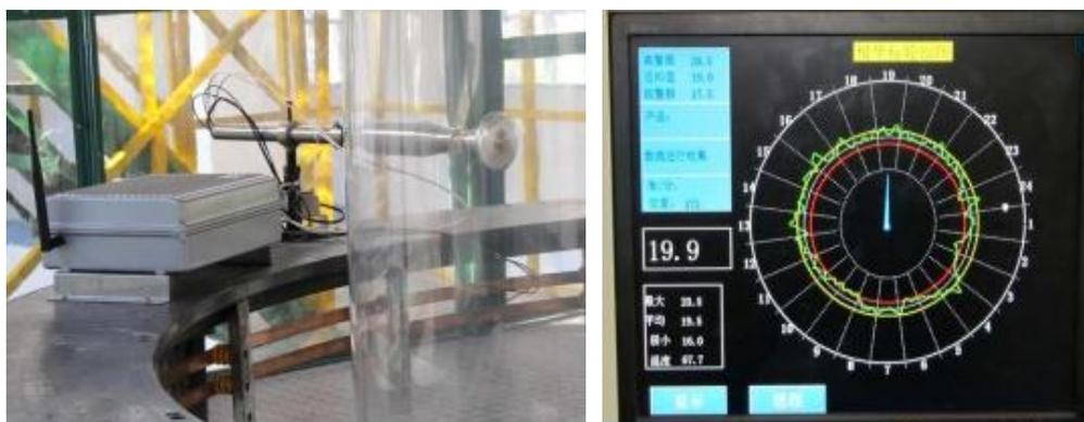
Рисунок 1.8. Внешний вид ёмкостного толщиномера WH/YMJDC-IIВ:
