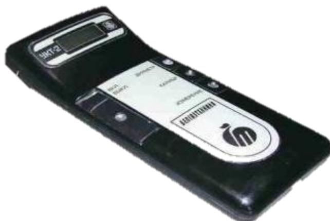
Рисунок 1.5 Внешний вид устройства контроля толщины
