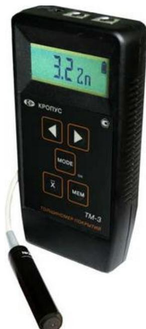
Рисунок 1.17. Внешний вид ТМ-3 вихретокового толщиномера
