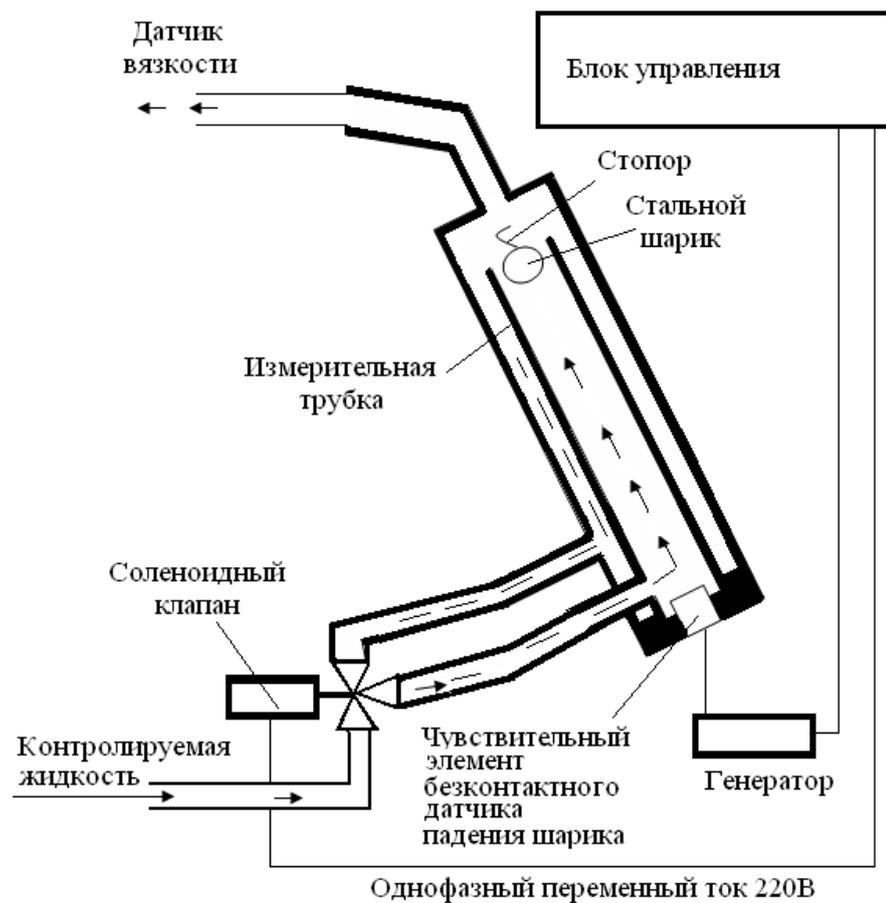
Рисунок 4 – Схема поточного вискозиметра с падающим шариком, модели JSW
