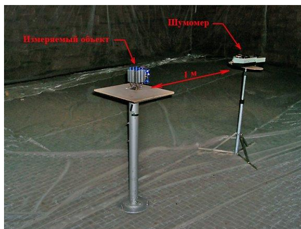
Рисунок 7.1 – Схема эксперимента по измерению уровней шума системы охлаждения ПК
