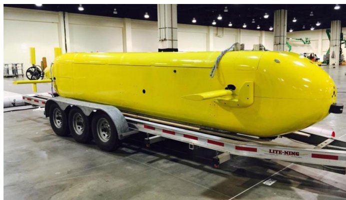
Рисунок 1.4 – АНПА LDUUV BMS США с рулевыми плоскостями
