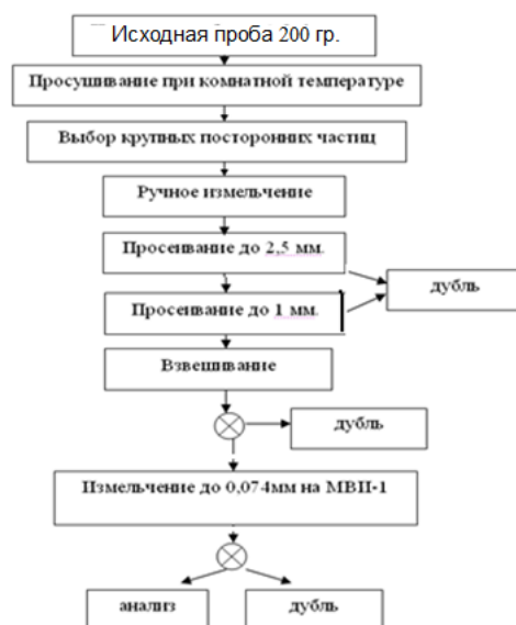
Рисунок 5.4.5 – Схема обработки и анализа проб донных отложений [11]
