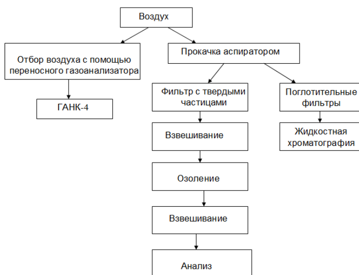
Рисунок 5.4.1. Схема обработки проб атмосферного воздуха [11]
