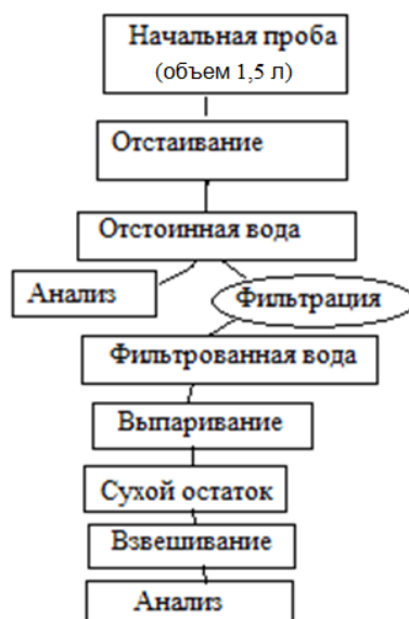
Рисунок 5.4.4 – Схема обработки и анализа подземных и поверхностных проб [11]
