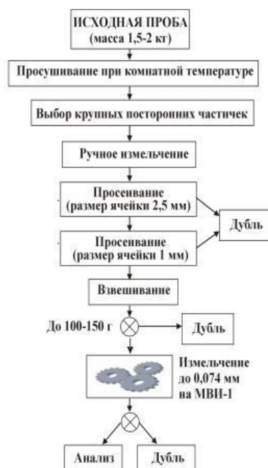
Рисунок 5.4.3 – Схема обработки и изучения литогеохимических проб [11]
