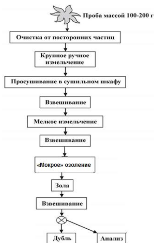
Рисунок 5.4.6 – Схема обработки и изучения проб растительности [11]
