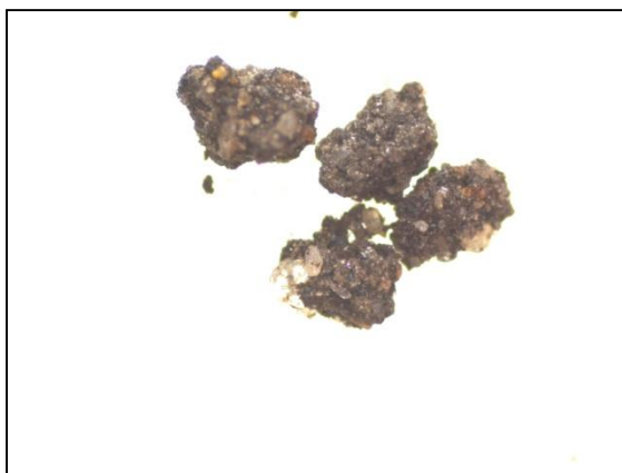
Рисунок 25. Сцементированные частицы (увеличение 16 x )[16]
