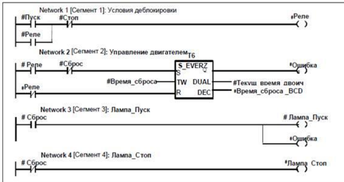
Рисунок 4.2 – Пример программы на языке LAD
