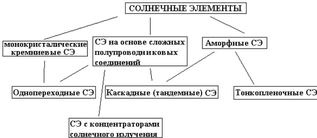
Рисунок 2. Конструкции солнечных элементов.
