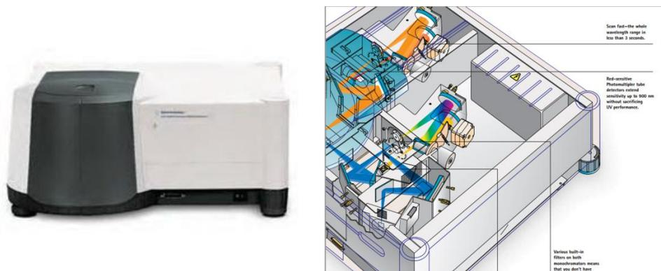
Рисунок 12 – Прибор спектрофлуориметр для исследования спектра люминесценции.
