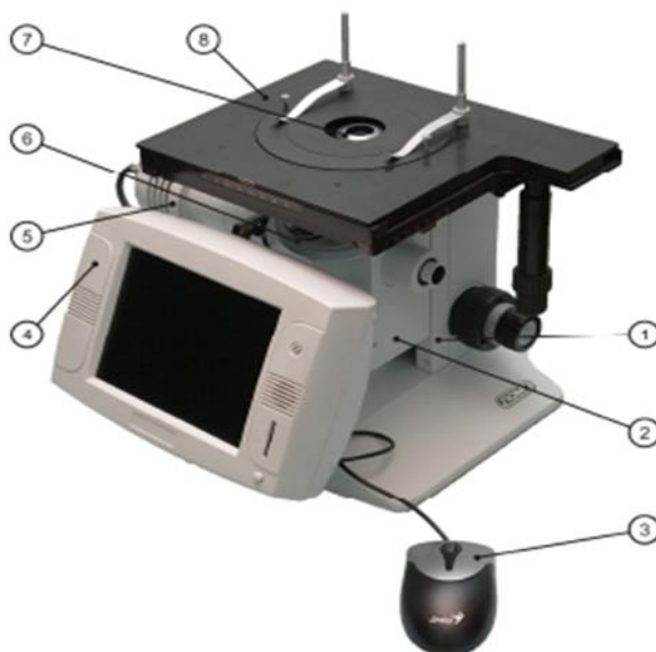
Рисунок 2.5. Микровизор металлографический \mu Vizo-MET-221.
